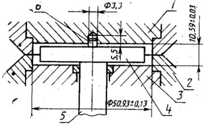
1—верхняя полуформа; 2—держатель полуформы; 3—нижняя полуформа; 4—головка ротора; 5—стержень ротора; 6—штифт ротора
